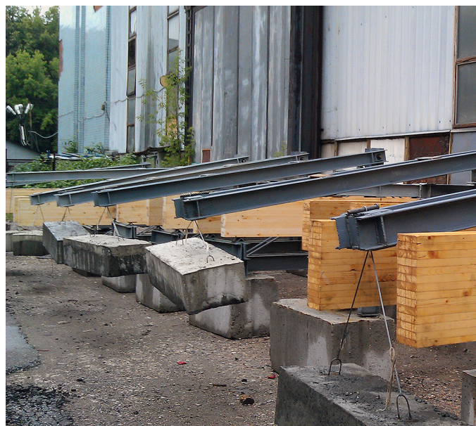
Элементы КДК при натурных испытаниях под нагрузкой
